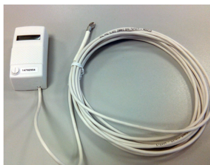
Sonde d'ambiance Version Remote Sensor avec 1 capteur intégré et 1 capteur déporté câble 2.5m
